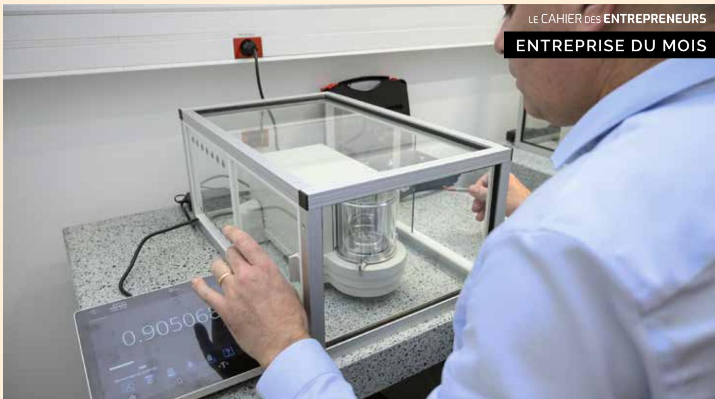
Nous proposons également le nettoyage, qui, comme son nom l'indique, permet de nettoyer le poids afin de le rendre conforme. Et enfin la restauration des poids et masses en fonte (à partir de 5 kg jusqu'à 2000 kg), qui consiste à effectuer un procédé de sablage, puis de peinture, avant un retour dans le process « classique » : ajustage, étalonnage suivi d'une vérification, afin de vérifier la conformité du poids ou de la masse.
